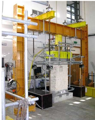
Fig. 4 - Sistema de ensaios de compressão axial, no início da campanha experimental [14, 16]
