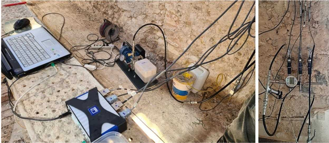
Fig. 3 – Equipamento usado nos ensaios realizados in situ com macacos planos (bomba hidráulica, sistema de aquisição de dados Quantum X data da HBM, ligado a um computador, e transdutores de deslocamento – com três canais longitudinais e um canal transversal).
