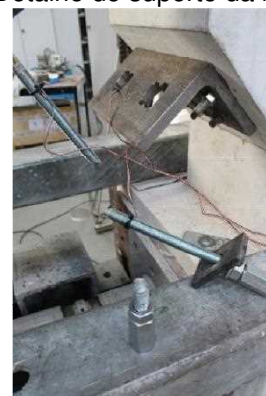
d) Detalhe da falha da barra
