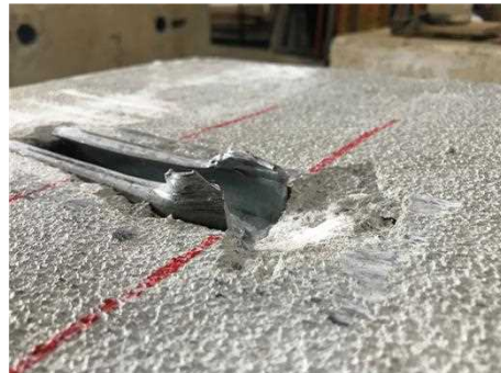
d) Falha do canal CPC_O_06
