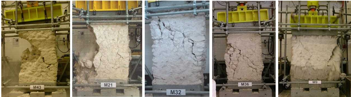
Fig. 5 - Ensaio em compressão axial dos muretes M43, M21, M32 [14], M36 [11] e M9 [3]
