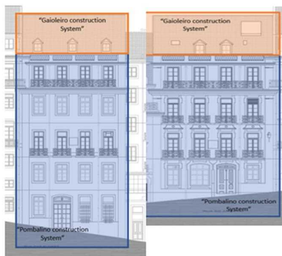
Fig. 2 – Fachadas com identificação da separação dos tipos de construção encontrados
