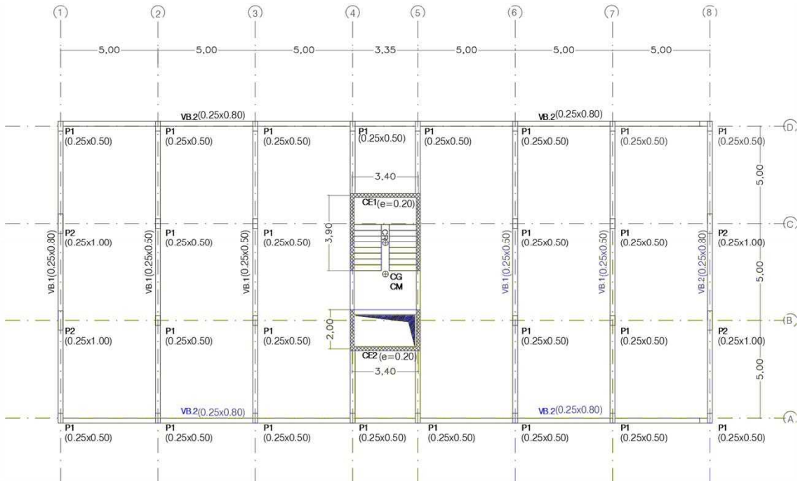
Fig. 1 – Planta estrutural do edifício A (EA).
