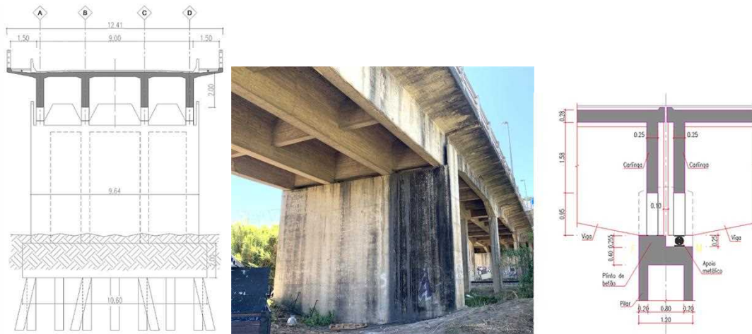
Fig. 13 – Pilares de junta das subestruturas dos viadutos e apoios do tabuleiro.
