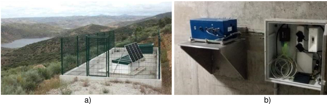
Fig. 7 - Vistas das estações sísmicas: a) remotas instaladas diretamente no maciço rochoso; e b) no interior das barragens
