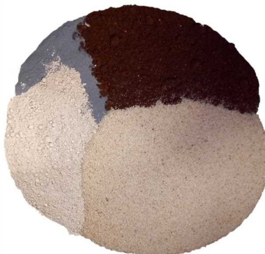
Fig. 1. Componentes sólidos da argamassa antes da mistura: cal hidráulica natural (NHL5), fumo de sílica, borra de café e areia ordinária.
