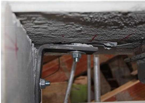
c) Parafuso expulso do canal CPC_O_06
