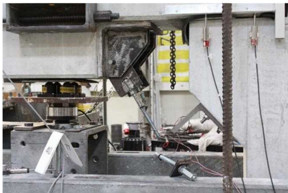
a) Visão geral da falha das barras
