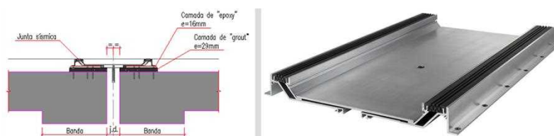
Fig. 6 – Juntas sísmicas – exemplo de um aparelho de junta com elevada capacidade.
